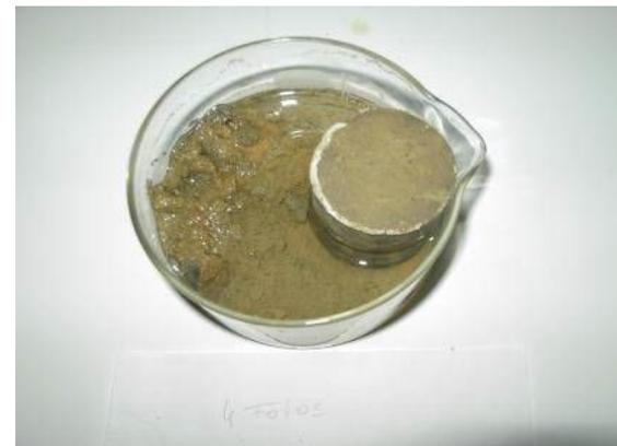
Wie man aus den Bildern ersehen kann, ist der behandelte Probekörper nach einer Woche noch immer stabil während der unbehandelte Körper sich nach 3 Stunden aufgelöst hat.
