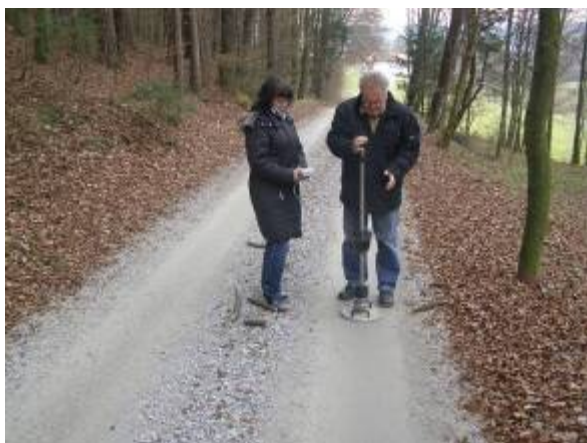
Messung der Tragfähigkeit
