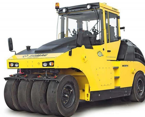
Pneumatikwalze für punktuelle Verdichtung, Gewicht mindestens 20 Tonnen
