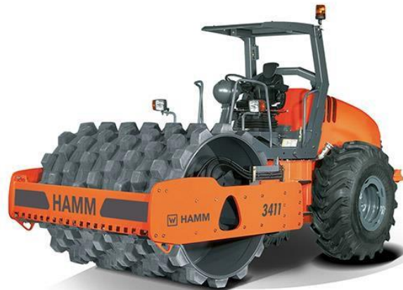
Stampffußwalze (Schafffußwalze) für grobe Verdichtung bindiger Böden, Gewicht mindestens 20 Tonnen
