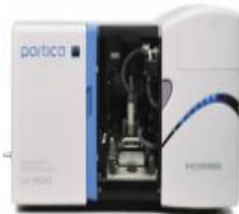
Alternativ zur reinen Äräometeranalyse/Sedimentationsanalyse nach DIN 18123 bzw. DIN EN ISO 17892-4 zur Bestimmung der Partikelgrößenverteilung <0,002mm bis 1mm, bietet sich das Laser-Streulichtspektrometer LA-960V2 von HORIBA an.
